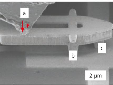
REM-Aufnahme einer Teststruktur mit der bereits positionierten Indenterspitze (a).
